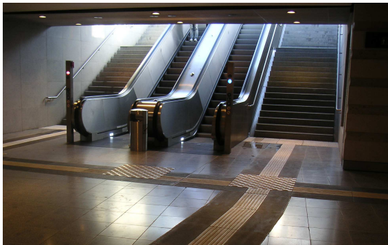
Abb. 14: Leitsystem in der S-Bahn Leipzig. Auf die abgehende Rolltreppe wird nur durch ein Abzweigefeld hingewiesen
